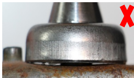
Schlechte Haftung wegen Luftspalt und reduzierter Auflagefläche
