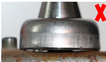
Schlechte Haftung wegen Luftspalt und reduzierter Auflagefläche
