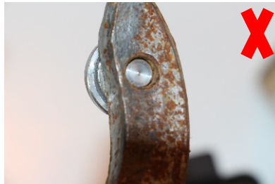
schlechte Lage der Bohrung
