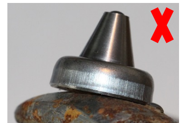
Schlechte Haftung wegen Luftspalt und reduzierter Auflagefläche
